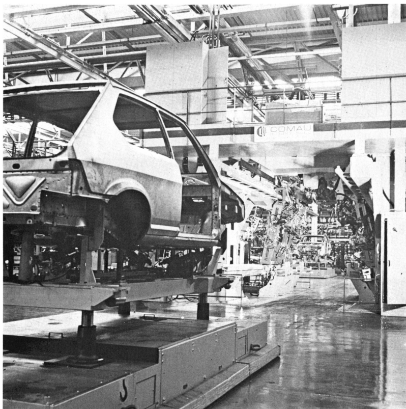
7. Il Robogate della Fiat. Il nome nasce dall'accoppiamento del robot al sistema delle « gate-lines », con cui viene prodotta ancora oggi la maggior parte delle automobili nel mondo.
